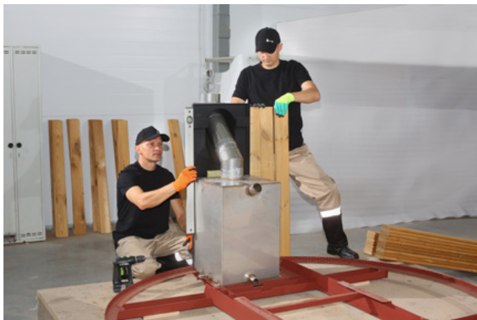
Ugradnja peći u metalni ram
